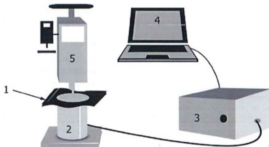
圖 1 改良式瞬態平面熱源傳導儀配置圖例
